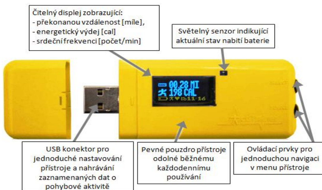
Obrázek 1 Multifunkční monitorovací přístroj ActiTrainer s popisem ovládacích prvků (Sigmund & Sigmundová, 2011).
