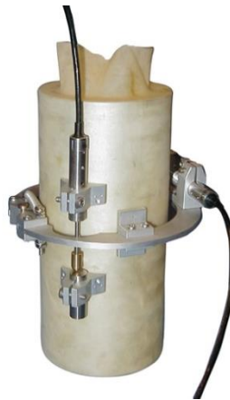
Obr. 3-1 Vzorek zeminy osazený snímači LVDT. Převzato z (GDS Instruments, 2020).
