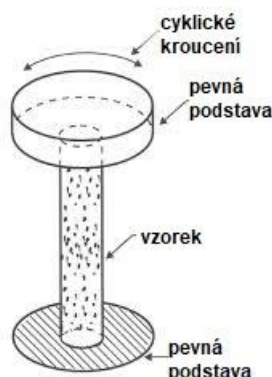
Obr. 3-3 Schéma zkoušky „ Resonant column “. Převzato z (NGI, 2020) a upraveno.
