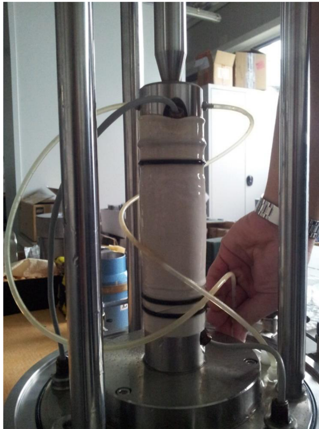
Obr. 4-2 Pohled na vzorek osazený v otevřené triaxiální komoře. Fotografie byla pořízena před vyjmutím vzorku z komory.
