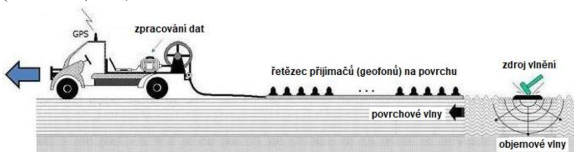
Obr. 3-8 Schéma měření pomocí metody MASW. Převzato z (GeoSiam Geophysical Services Co., Ltd., 2020) a upraveno.
