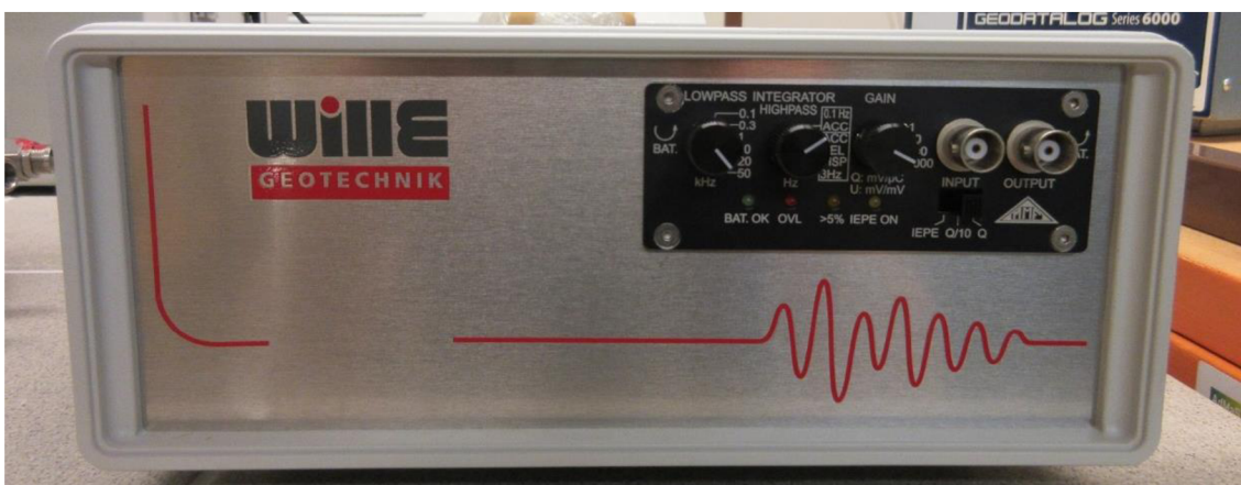
Obr. 4-5 Ovládací panel osciloskopu. Otočné ovladače zleva jsou postupně LowPass filtr, HighPass filtr, a následují konektory pro spojení s bender elementy.
