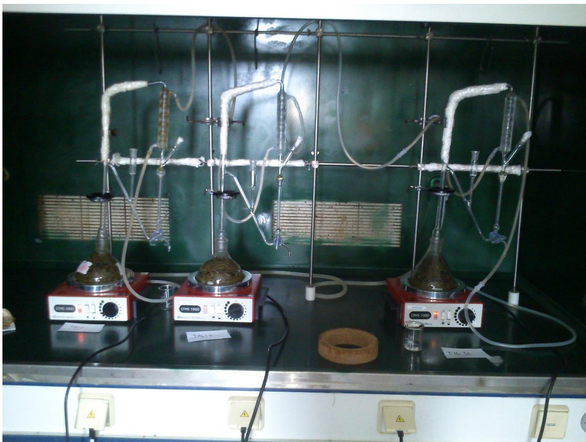
Obr. č. 4: Destilační aparatura s připravenými vzorky.
