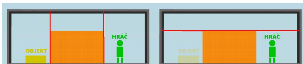
Obrázek 16 – Výchozí rozdělení visleafs ze strany vs. manuální rozdělení (vlastní zpracování)
