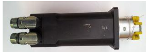
a) Funkční vzorek, [58] KURFÜRST, J.; ONDRŮŠEK, Č.; DUROŇ, J.: OSM_6000; Optimalizovaný synchronní stroj s PM na rotoru. firma: Kollmorgen, s.r.o., Evropská 864, Modřice, 664 42. URL: http://www.uvee.feec.vutbr.cz/fvzorky
