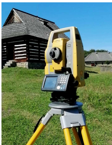
Obr. 10: Totálna stanica Topcon DS-103AC
