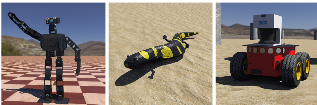
Obr. 25: Príklady simulácie robotov vo Webots (vľavo robot Robotics-Op3, v strede model robota Salamander, vpravo robot Pioneer 3-AT ). [47]
