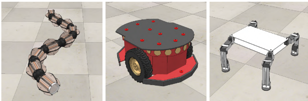
Obr. 27: Príklady simulácie robotov v prostredí CoppeliaSim (vľavo robot ACM-R5, v strede robot Pioneer 3-DX, vpravo robot rollerWalker).
