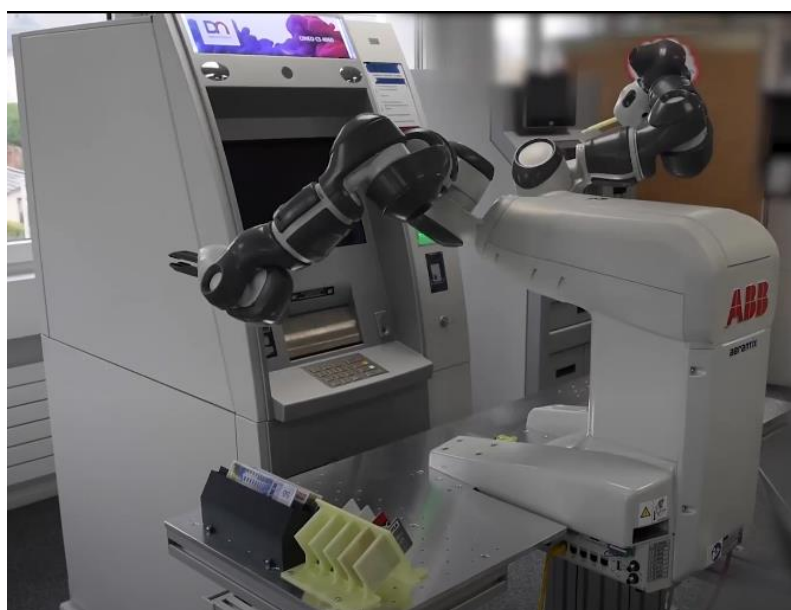
Obrázek 19 Testování bankomatů robotem YuMi [30]
