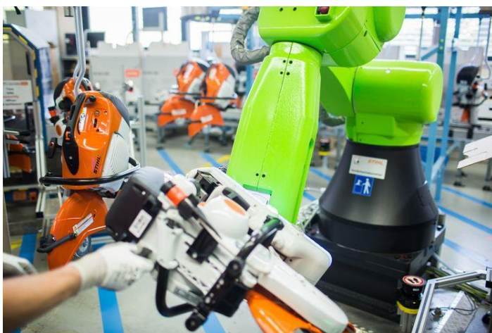
Obrázek 24 Robot FANUC CR-35iA ve společnosti STIHL [35]
