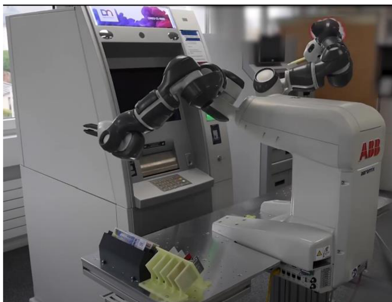
Obrázek 19 Testování bankomatů robotem YuMI [30]
