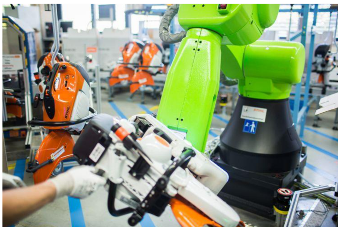
Obrázek 24 Robot FANUC CR-35iA ve společnosti STIHL [35]
