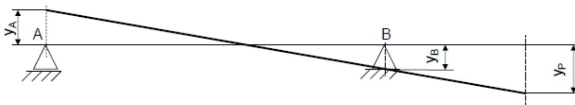
Obr. 70: Deformace ložisek (tuhé vřeteno) [63]
