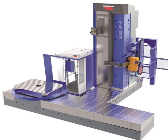
Obr. 3: Křížová horizontální vyvrtávačka WHR 13 (Q) [6]
