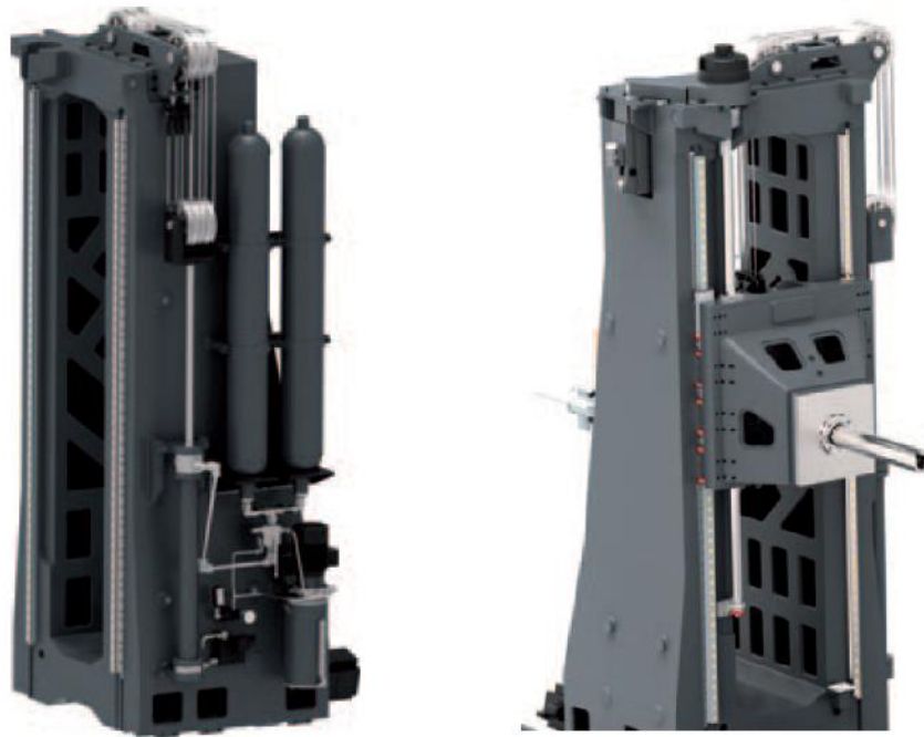
Obr. 11: Kompenzace hmotnosti vřeteníku [16]
