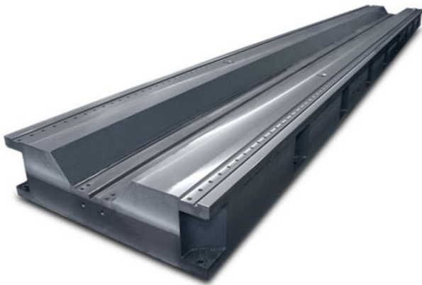
Obr. 9: Litinové lože firmy STOLLE [14]
