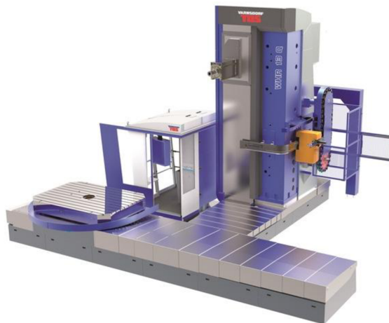
Obr. 3: Křížová horizontální vyvrtávačka WHR 13 (Q) [6]
