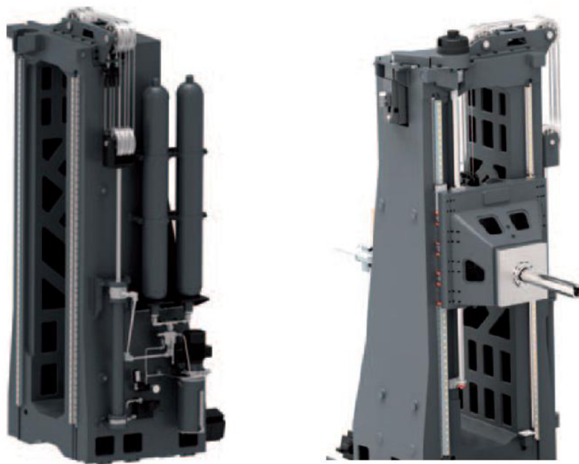
Obr. 11: Kompenzace hmotnosti vřeteníku [16]
