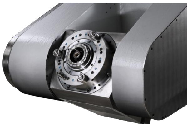
Obr. 35: Naklápěcí vřeten firmy BURKHARDT + WEBER [41]
