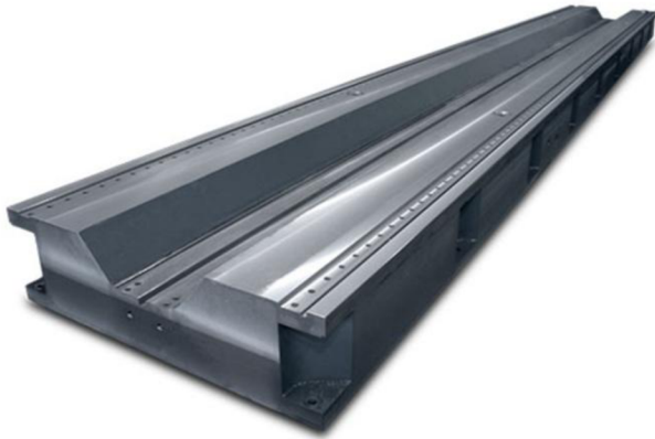
Obr. 9: Litinové lože firmy STOLLE [14]
