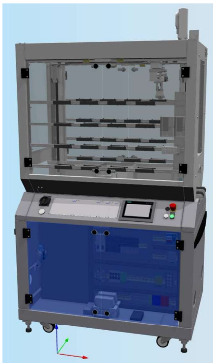
Obr. 9: Moduly buňky a) víceúrovňový sklad, b) robotická osazovací buňka [13]
