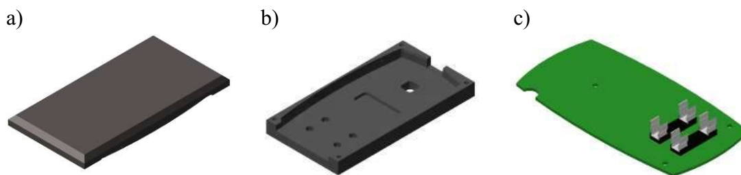
Obr. 6: Zjednodušený model mobilního telefonu a) Zadní kryt, b) Přední kryt, c) Deska plošných spojů [13]
