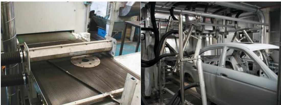
Obr. 2.11 Umístění vzduchových nožů, [10]
