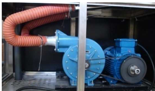
Obr. 4.6 a) Turbo ventilátor 587, b) Kompresor Cyclon 218
