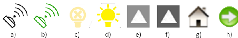
Obr. 6.6: Ikony ovládání světel ve webovém rozhraní: a) PIR sensor nezaznamenal pohyb, b) PIR sensor zaznamenal pohyb, c) světlo vypnuté, d) světlo zapnuté, e) ovladač vypnutý, f) ovladač zapnutý, g) přechod na úvodní stránku, h) přechod na jinou stránku.
