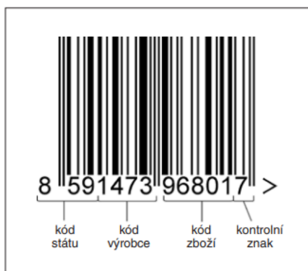
Obrázek 3: 1D čárový kód EAN-13 Zdroj: Šoustek a Matoušek, 2012
