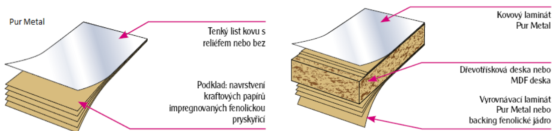
Obr. 5.3 Kovolaminát, kovolaminát na nosné desce [14]
