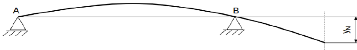
Obr. 25: Průhyb vřetene zatíženého silou F za předpokladu, že ložiska jsou tuhá [33]
