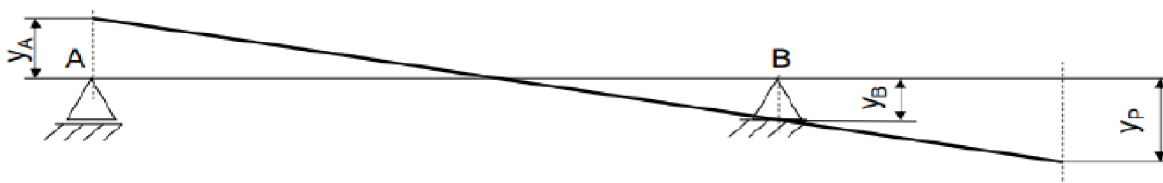
Obr. 26: Průhyb vřetene za předpokladu, že ložiska jsou poddajná a vřeteno tuhé [33]
