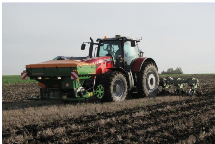
Obr. 7 Pásové kypření půdy na podzim (10. 10. 2012)
