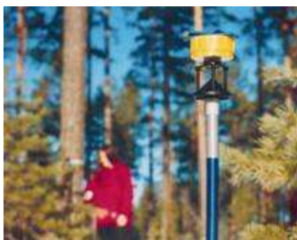
Transpondér (aktivní odrazka) na monopodu ( http://www.silvinova.cz/lesnictvi/ )
