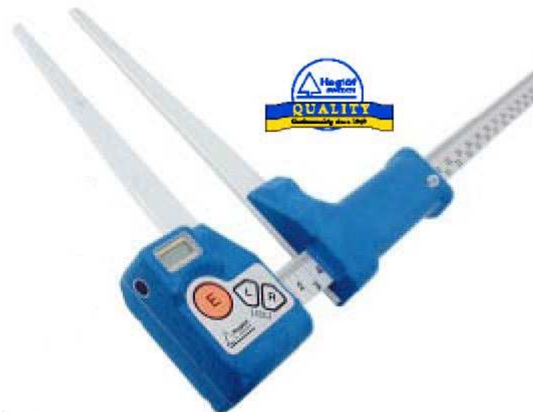
Registrační průměrka Mantax DigiTech ( http://www.silvinova.cz/lesnictvi/ )
