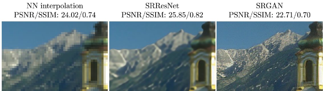
Obr. 3.3: Inkonzistencia hodnôt PSNR a SSIM voči perceptuálnej kvalite obrázka. Vľavo je obrázok, ktorého rozlíšenie bolo zvýšené pomocou jednoduchej interpolácie algoritmom najbližšieho suseda (spomenutý v časti 3.2). V strede je obrázok, ktorý je výstupom neuronovej siete SRResNet [23], ktorej cieľom bolo dosiahnuť čo najlepšie hodnoty PSNR a SSIM. Nakoniec vpravo je výstup zo siete SRGAN [23], ktorá mala za úlohu maximalizovať perceptuálnu kvalitu obrazu. Hodnoty PSNR a SSIM sú vyššie pri interpolácii metódou najbližšieho suseda ako pri sieti SRGAN, ale vizuálny dojem hovorí presný opak. Obrázok prevzatý z [3].
