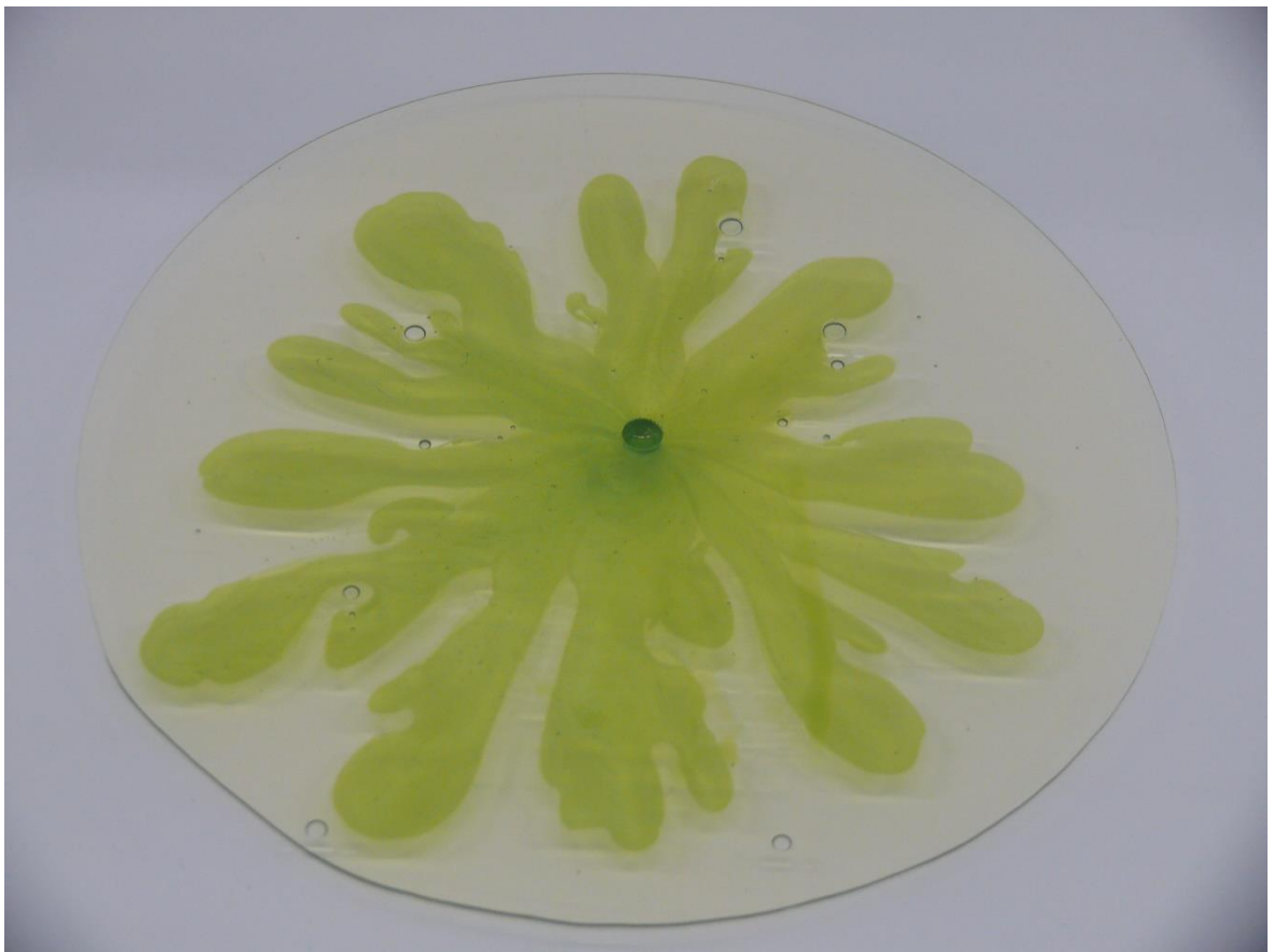
Obrázek P5: Hele-Shawova buňka – Med a mýdlo
