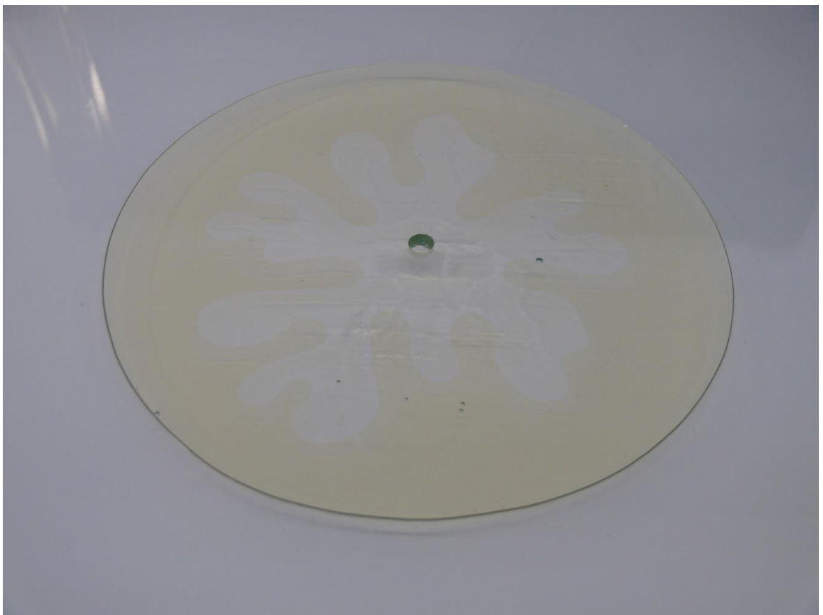
Obrázek P6: Hele-Shawova buňka – Med a olej
