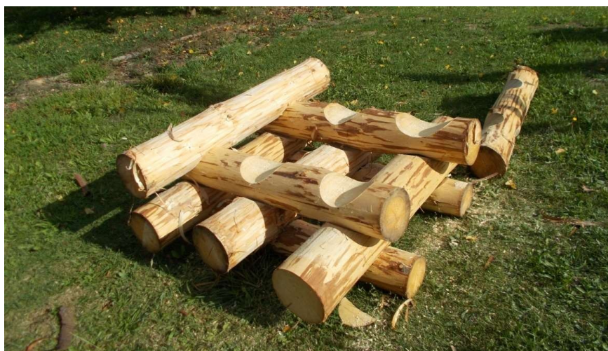
Obrázek 8 – Vzorek řezaný pásovou pilou oboustranný Zdroj: vlastní
