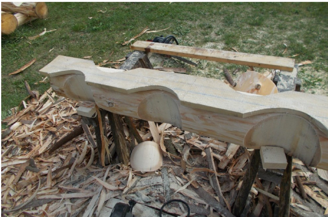
Obrázek 15 – Vytvoření šablony na vyřezávání pásovou pilou Zdroj: vlastní
