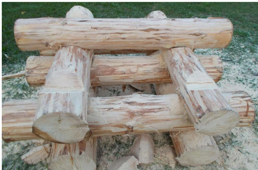
Obrázek 7 – Vzorek řezaný ruční motorovou pilou Zdroj: vlastní
