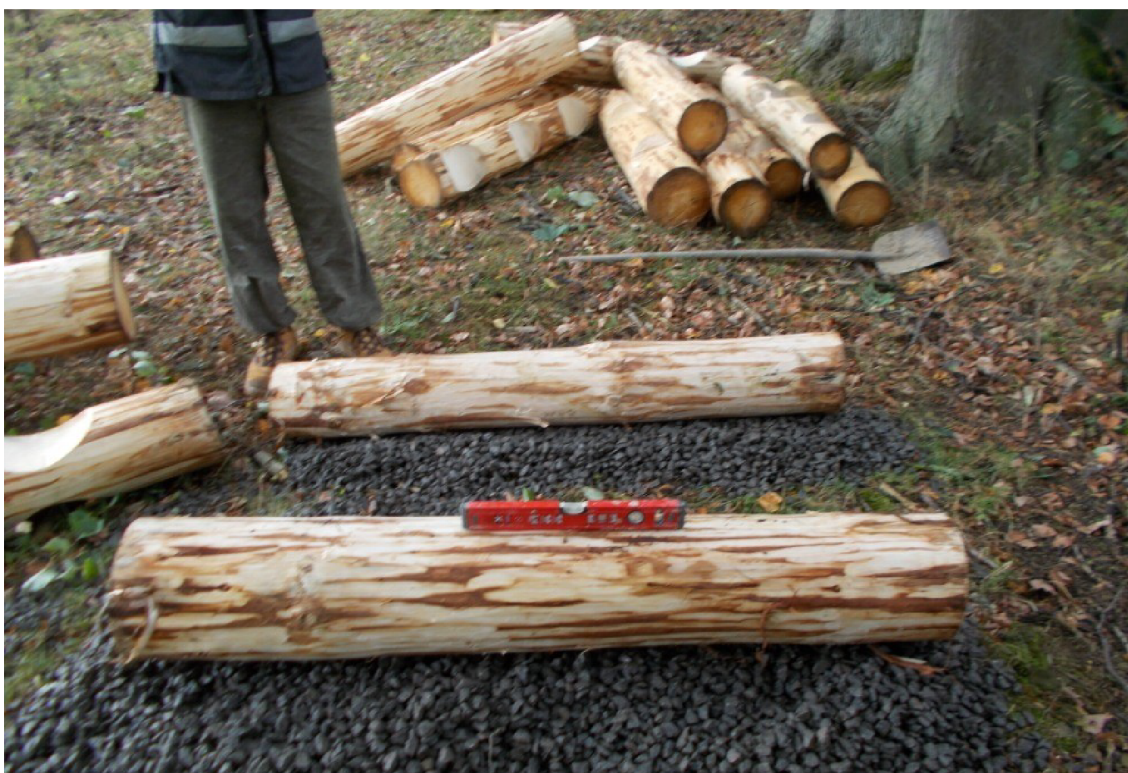
Obrázek 18 – Zvednutí vzorků kamennou drtí nad terén Zdroj: vlastní
