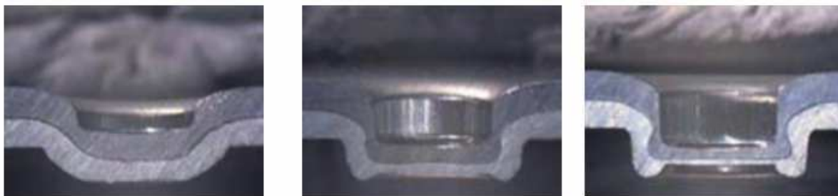
Obr. 10 Fáze tvoření spoje, tvorba pevného spojení materiálu a finální spoj [35]
