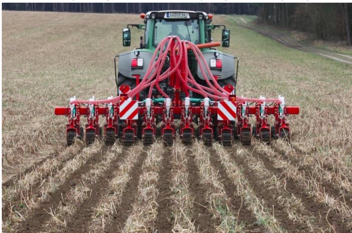
Obr. 3: Provedení pásů strojem Kverneland Kultistrip do vymrznuté meziplodiny
