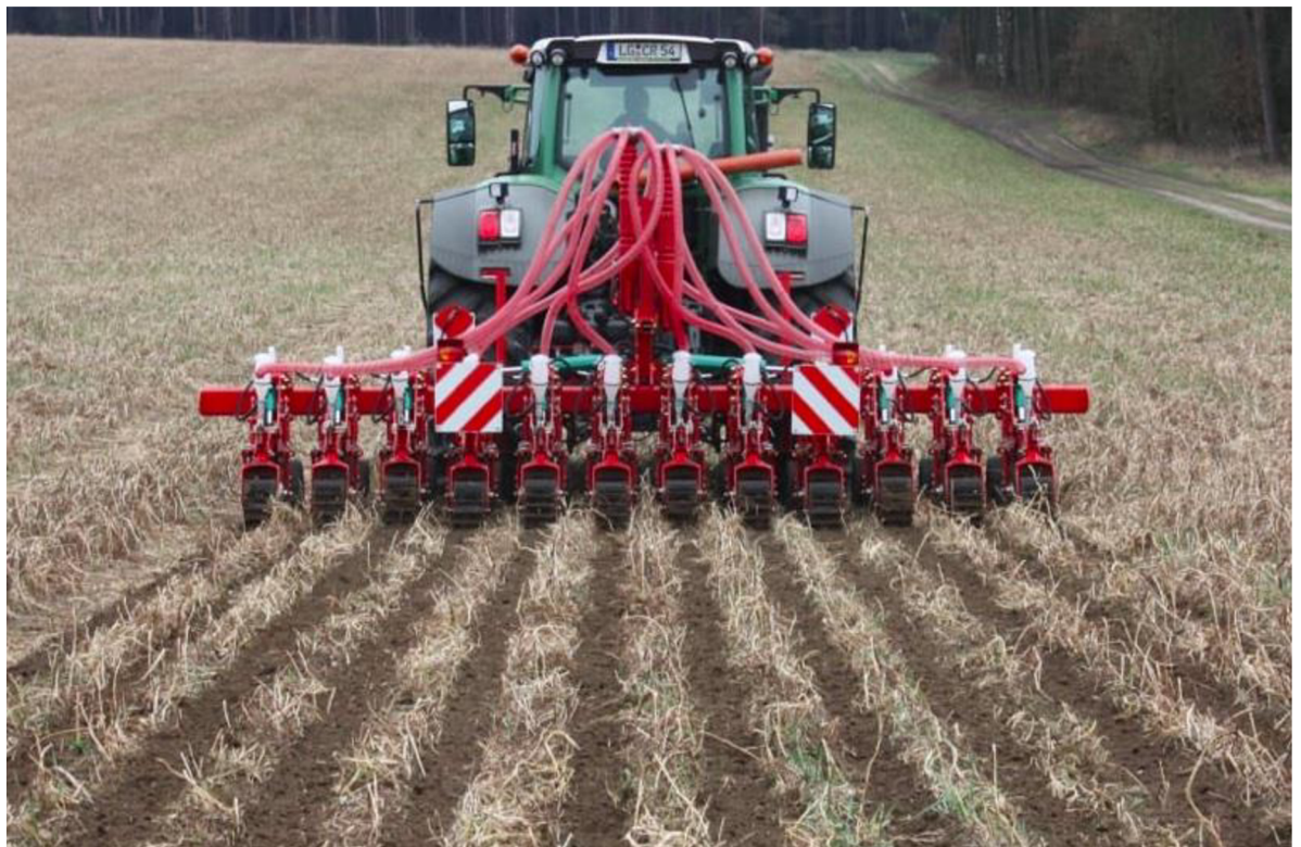
Obr. 3: Provedení pásků strojem Kverneland Kultistrip do vymrznuté meziplodiny
