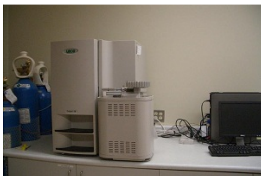
obr. č. 10: CN Determinator Systém TruSpec-CN Leco. Zdroj: http://www.brandonu.ca
