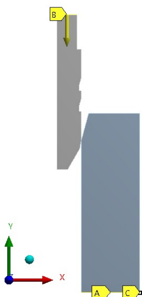
Obrázek 42: Okrajové podmínky výpočtu lisovacího procesu
