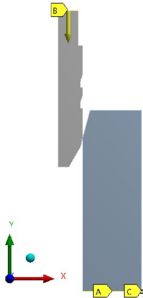
Obrázek 42: Okrajové podmínky výpočtu lisovacího procesu
