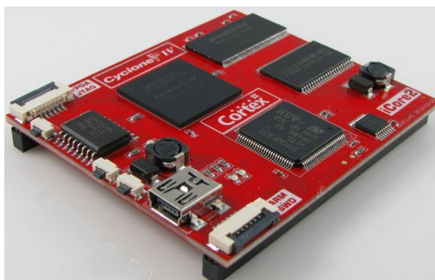
Obr. 2.14: Modul s osadeným 32-bitovým MCU STM32 a FPGA Altera CYCLONE IV
