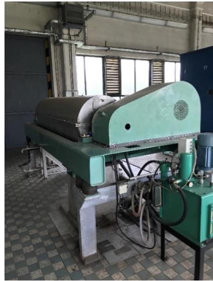
Obr. 6.13 a 6.14 - Na levém obrázku je kalové hospodářství a na pravém zhušťovací odstředivka (vlastní 2019)
