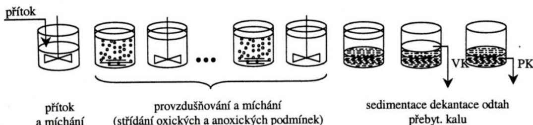
Obr. 3.9 - Schéma SBR procesu (Hlavínek a kol. 2003)
