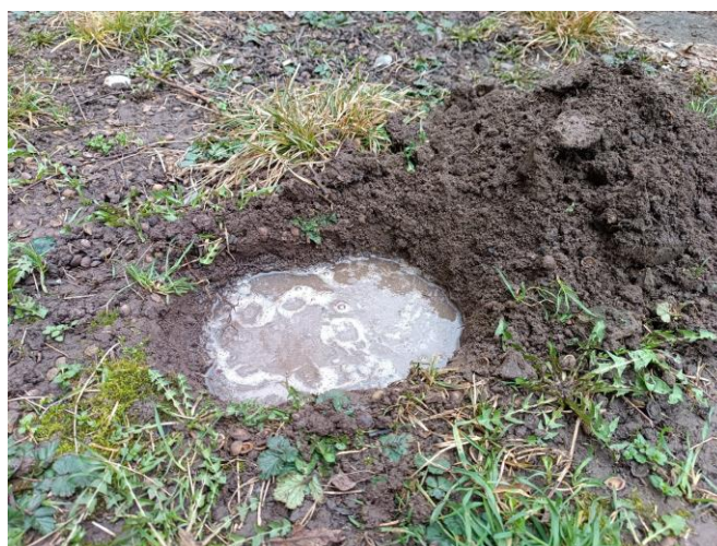
Obrázek 15: Jáma naplněna 3,5 litru vody (archiv autorky, 2024)
