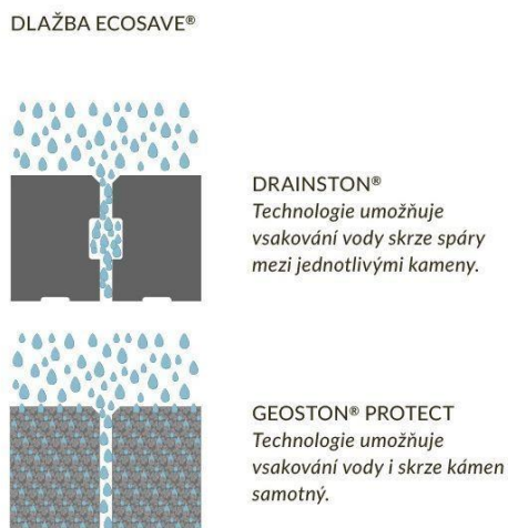
Obrázek 5: ukázka technologie propustné dlažby Ecosave (Brožová, 2020)
