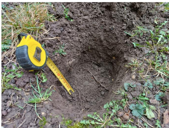
Obrázek 14: 15 cm hluboká jáma pro test vsakovatelnosti (archiv autorky, 2024)
