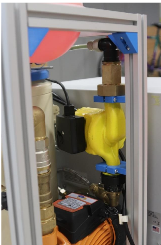
Obrázek 4-4 Uchycení čerpadla primárního okruhu
