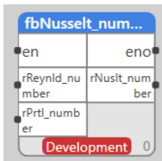
Obrázek 5-13 Funkční blok pro výpočet Nusseltova čísla
