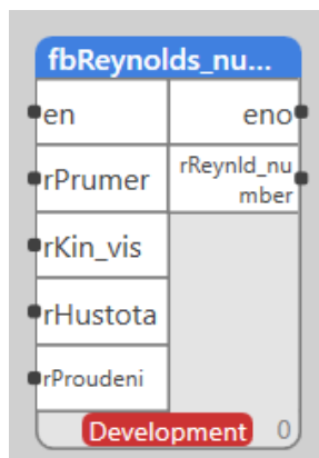
Obrázek 5-11 Funkční blok pro výpočet Reynoldsova čísla
