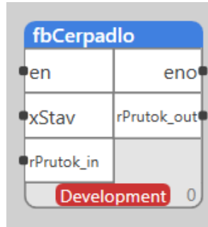
Obrázek 5-9 Funkční blok čerpadla
