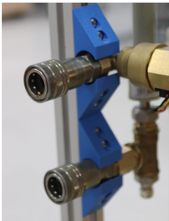
Obrázek 4-7 Upevnění bezokapových svorek
