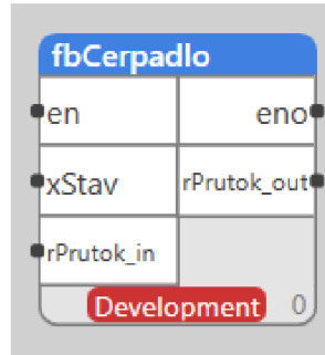
Obrázek 5-9 Funkční blok čerpadla
