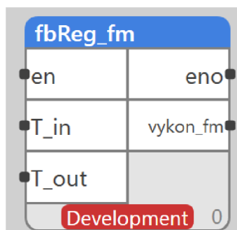
Obrázek 8-2 Funkční blok regulátoru průtoku
