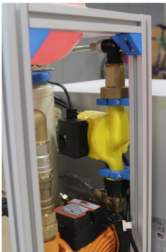
Obrázek 4-4 Uchycení čerpadla primárního okruhu
