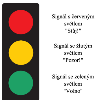
Obrázek 2.4: Semafor s plnými terci a popisem jednotlivých signálů [13]
