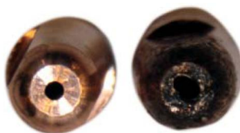
Obr. 29 Kontaktní průvlaky, vlevo nový, vpravo opotřebovaný.[4]
