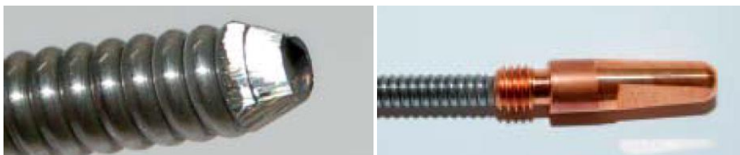
Obr. 30 Úprava konce vodítka broušením a sestavení. [4]
