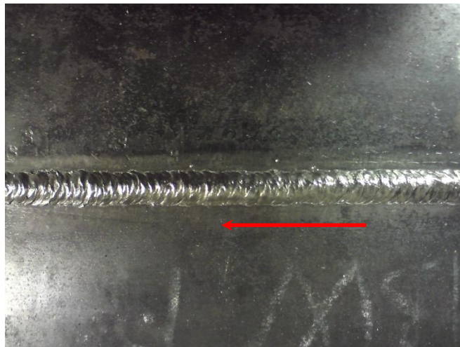
Obr. 57 Kresba svaru BW PA.
