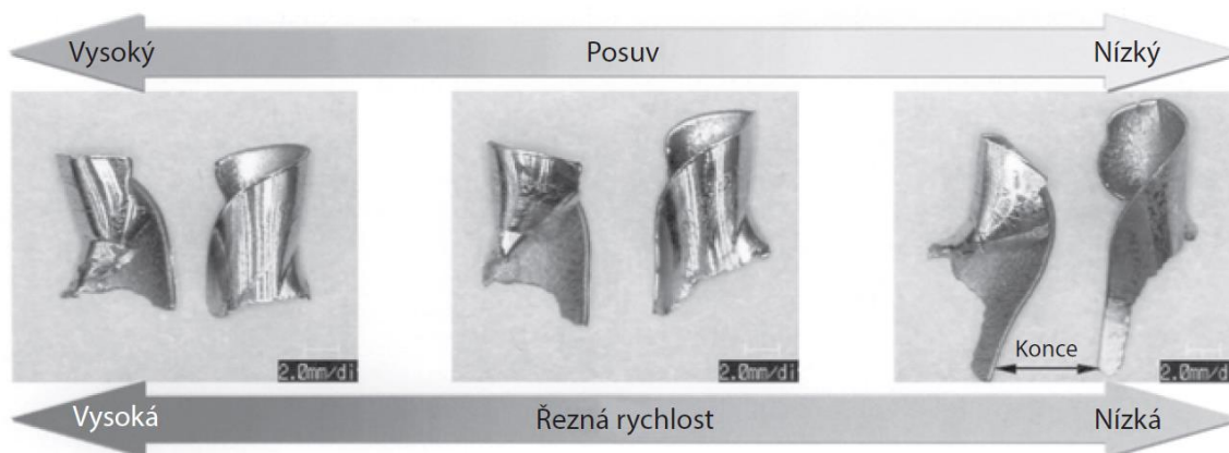
Obr. 1.14 Změna tvaru třísky v závislosti na řezných parametrech [9].
