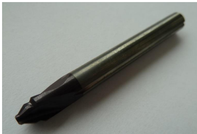
Obr. 4.7 Původní nástroj pro výrobu kuželového osazení.
