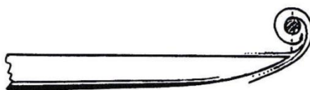
Obrázek 6.2 Tvar křídla v podélném řezu
