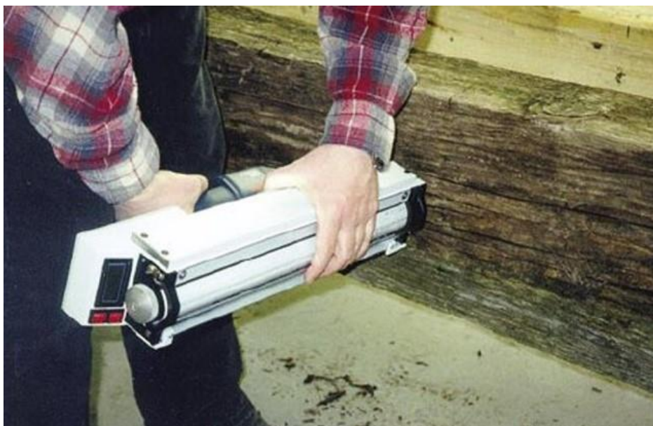
Obr. 7: Odporové mikrovrtání na zabudovaném dřevěném prvku
