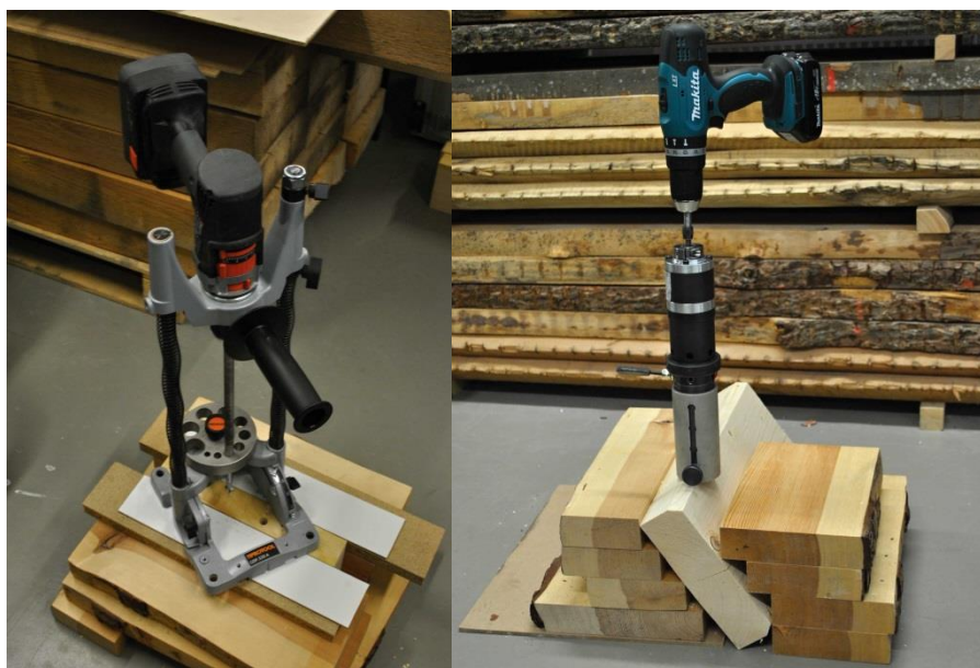
Obr. 17: Nástroj zajišťující kolmost při vrtání kruhového otvoru (vlevo), roztlačovací zařízení čelistmi vložené do otvoru a připravené k měření (vpravo)
