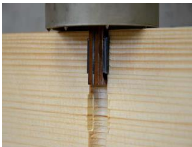
Obr. 9: Čelisti měřícího zařízení vložené do předvrtaného otvoru
