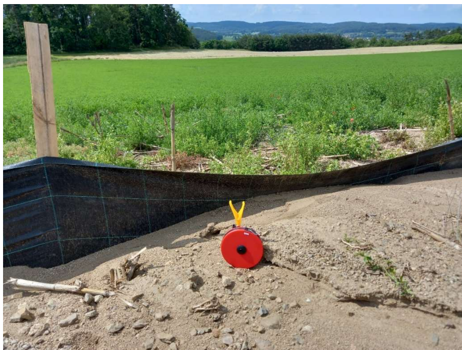
Obrázek 26 - nános sedimentu pod rýhami 9 – 11, parcela 1 - zdroj vlastní
