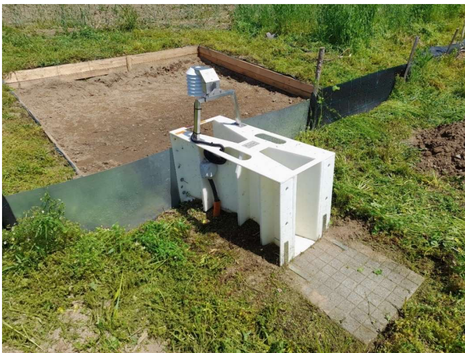
Obrázek 5 - napojení Parshallova žlabu na silt-fence, zdroj vlastní
