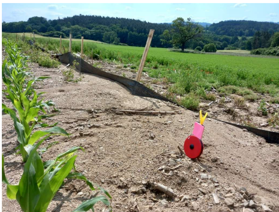
Obrázek 27 - nános sedimentu pod rýhou 5 - 6, parcela 1 - zdroj vlastní
