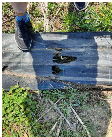
Obrázek 10 - poškození svodné textilie, zdroj Gregar, Petrů
