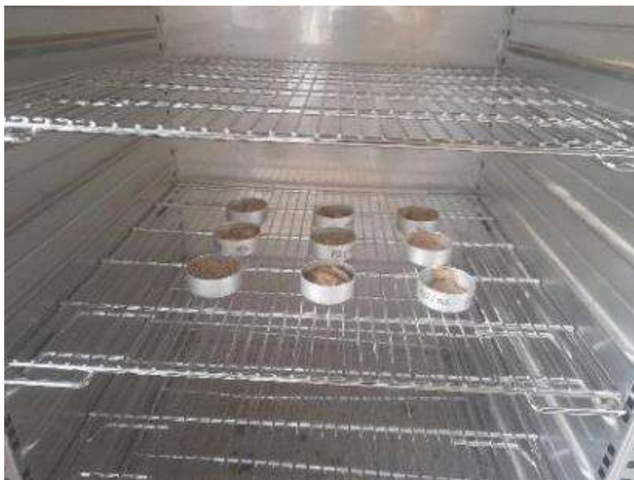
Obrázek 51 – váženky v sušičce, zdroj vlastní
