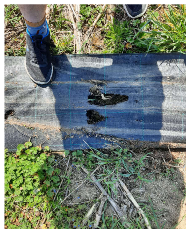
Obrázek 10 - poškození svodné textilie, zdroj Gregar, Petrů
