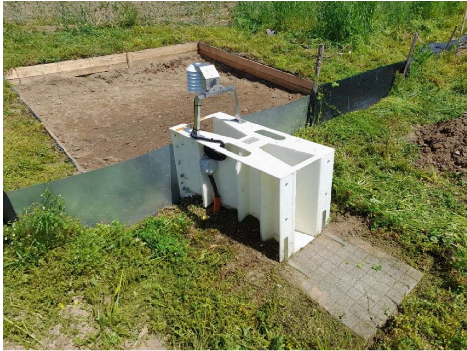
Obrázek 5 - napojení Parshallova žlabu na silt-fence, zdroj vlastní
