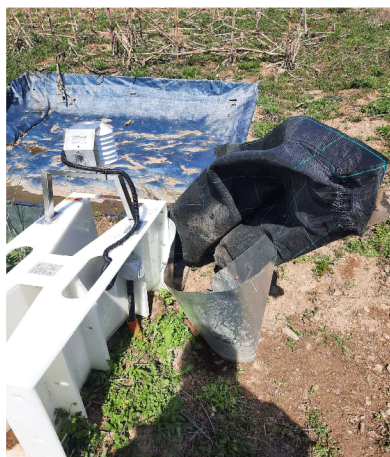
Obrázek 9 - poškození jímky a napojení na svodnou textilii, zdroj Gregar, Petrů
