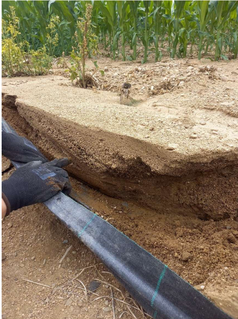
Obrázek 14 - výška sedimentu u svodné textile - zdroj Daniel Špírek
