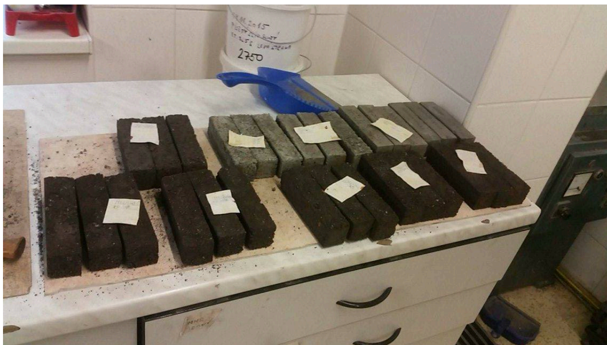
Obrázok 10: Vyrobené trámiky zo systému na báze portlandského cementu a fluidného popolčeka
