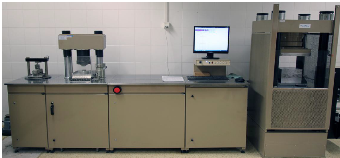
Obrázok 9: Hydraulický lis použitý na mechanické testovanie
