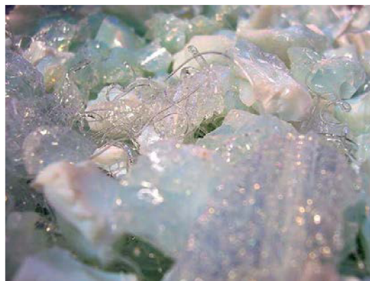
Obrázok 8: Frita vzniknutá ochladením roztaveného sklárskeho piesku s \text{Na}_2\text{CO}_3 [37]
