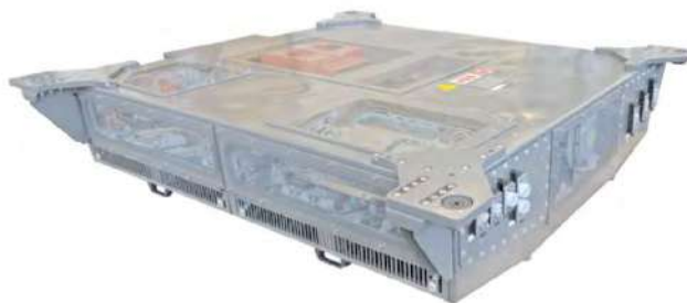
Obr. 2. 26 Trakční měnič Compact Converter BORDLINE® CC400 [39]
