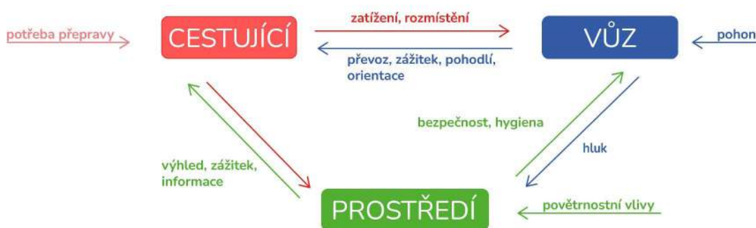
Obr. 2. 16 Schéma cestující – vůz – prostředí
