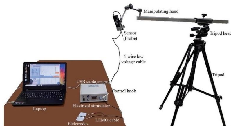
Obrázek 2 Instrumenty pro měření pomocí TMG (Park, 2020).
