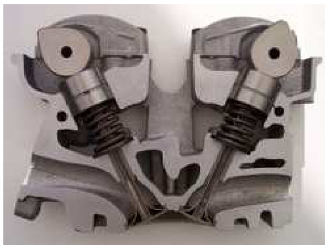
Obr. 2.4.3 Ventilový rozvod DOHC [3]
