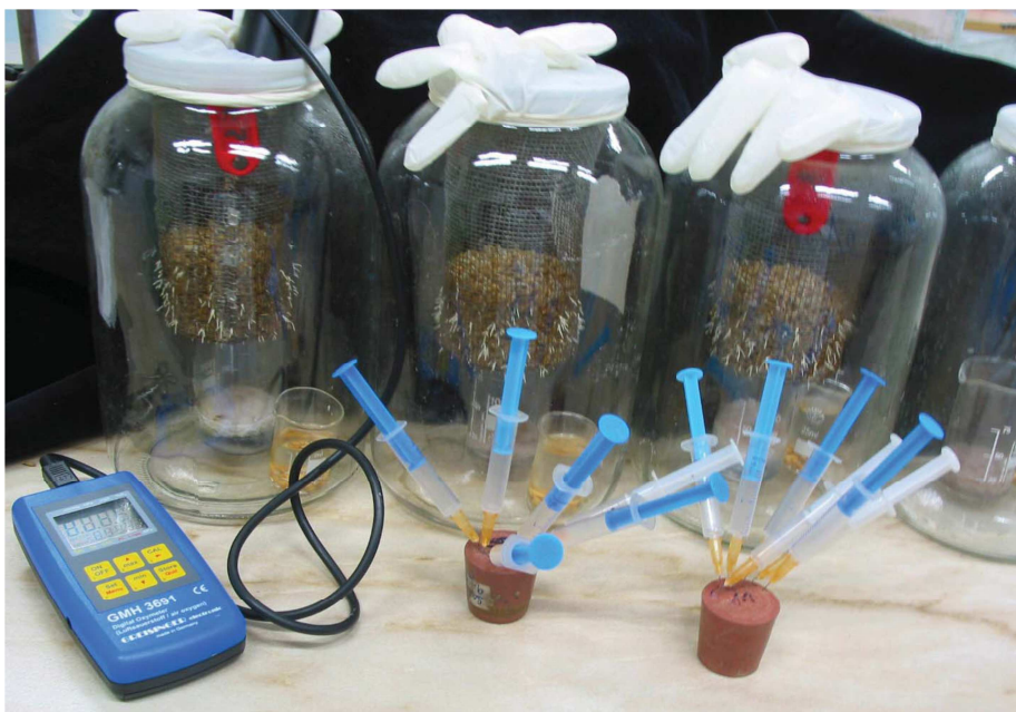
Obr. 6: Způsob odběru plynů z kultivačních nádob a měření kyslíku (FIŠEROVÁ, 2013)
